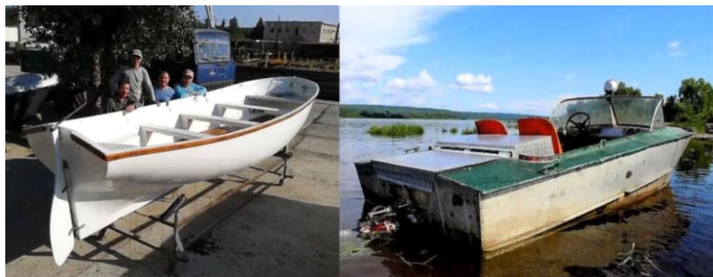
Рисунок 17. Внешний вид корпусов гребной лодки (слева) и глиссирующего катера (справа). Хорошая мореходность (всхожесть на волну) у гребной лодки обеспечиваются малыми объемами водоизмещения (острыми ватерлиниями) в носу и корме. А подводная часть кормы глиссирующего катера широкая и плоская.
