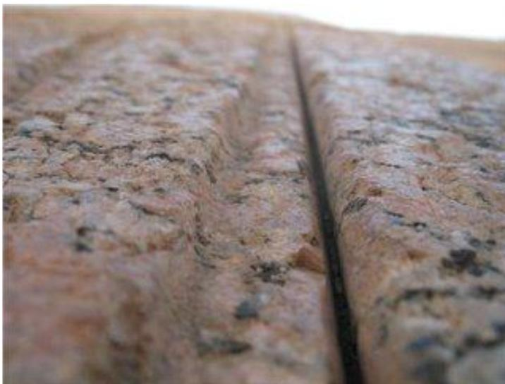
Рисунок 9 Пропилы на поверхности гранитного блока
