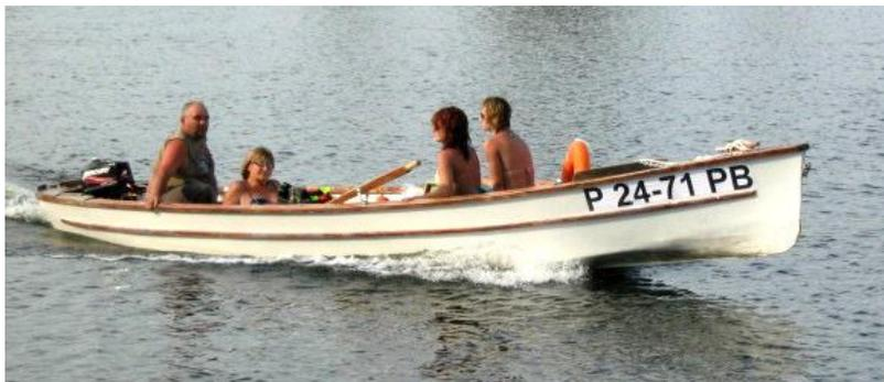
Рисунок 19. Движение лодки в переходном режиме. Хорошо виден задранный нос лодки. Реальная длина ватерлинии сократилась более чем на метр, еще более усугубляя неэкономичность режима движения.
