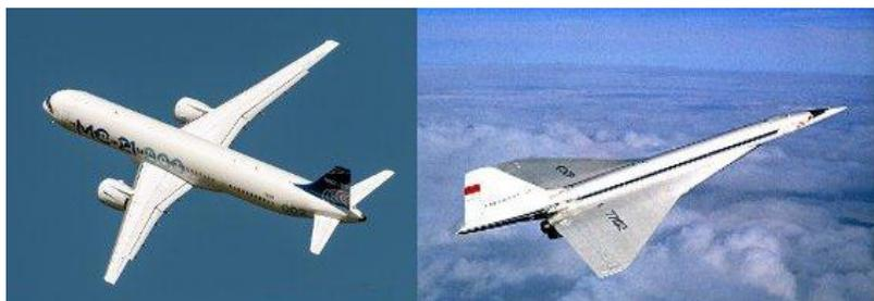
Рисунок 11. Пассажирские самолеты. Дозвуковой MS-21 слева и сверхзвуковой Ту-144 справа
