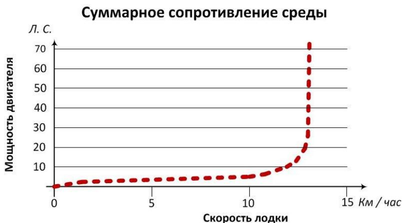
Рисунок 10. Зависимость суммарного сопротивления среды движению гребной шлюпки
